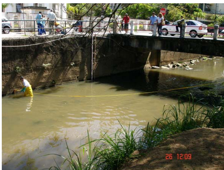
Figura 12 - Estação Liceu tipo PrFrDA, rio Piabanha – tubo do sensor, réguas e medição de vazão
